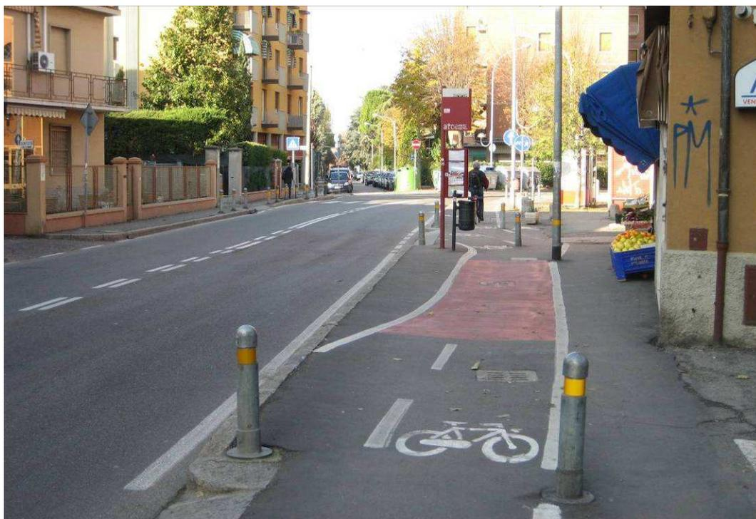
*Bologna, via Arcoveggio, buona soluzione per la fermata del Trasporto Pubblico mediante restringimento puntuale della pista ciclabile, il restringimento e il transito dei pedoni viene evidenziato con una coloritura rossa della pavimentazione*
