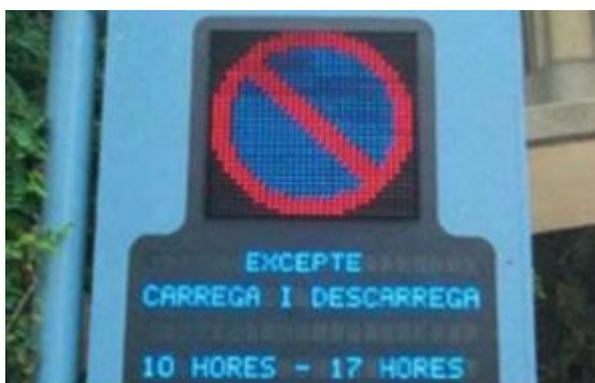
**Figura 6-3** Particolare del pannello a messaggio variabile che regola l’utilizzo della Multiple use lane, si può notare come la sosta sia vietata per tutti i veicoli ad eccezione di quelli adibiti alle operazioni di carico/scarico
