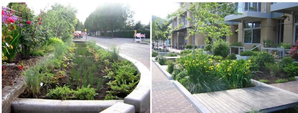
Figura 7-3 Vasche di laminazione alla scala locale (Pocket wetlands)
