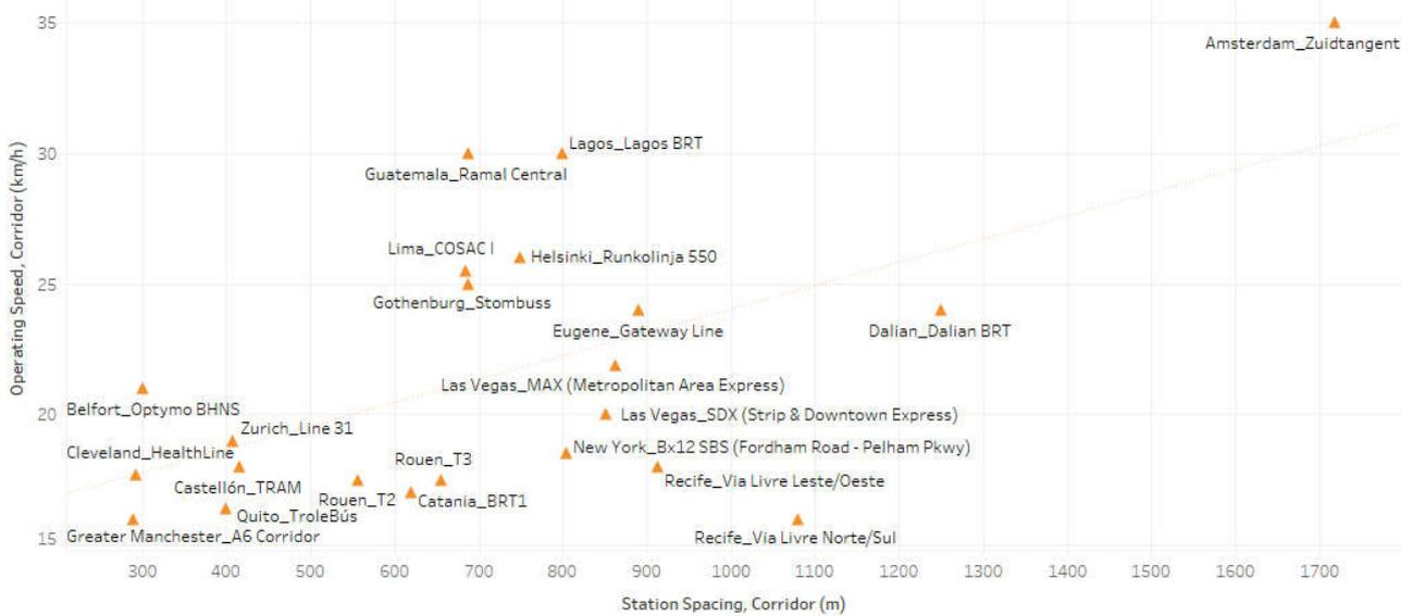
Figura 4-6: correlazione tra velocità commerciale e densità tra le fermate
