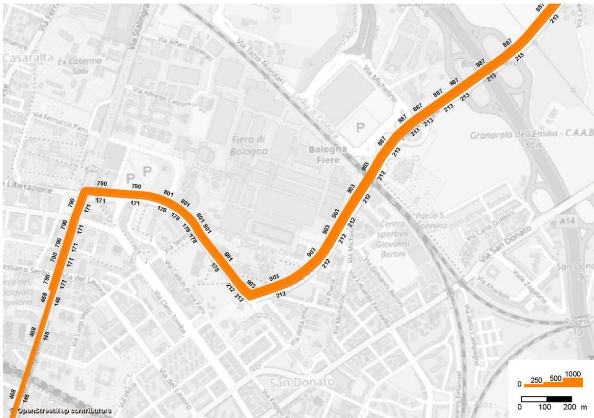
Figura 7-1: sezione massimo carico del sistema Metrobus – dato in passeggeri/ora (zona viale della Fiera - Bologna)
