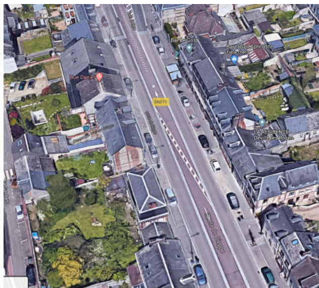
Figura 6—2: esempio di sede riservata, non segregata, con corsia mista per le due direzioni del BRT – particolare del punto di variazione della direzione (Rouen)
