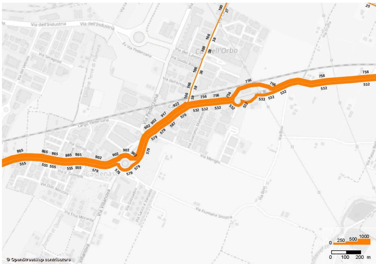
Figura 7-1: sezione massimo carico del sistema Metrobus – passeggeri/ora (zona Cà dell'Orbo)
