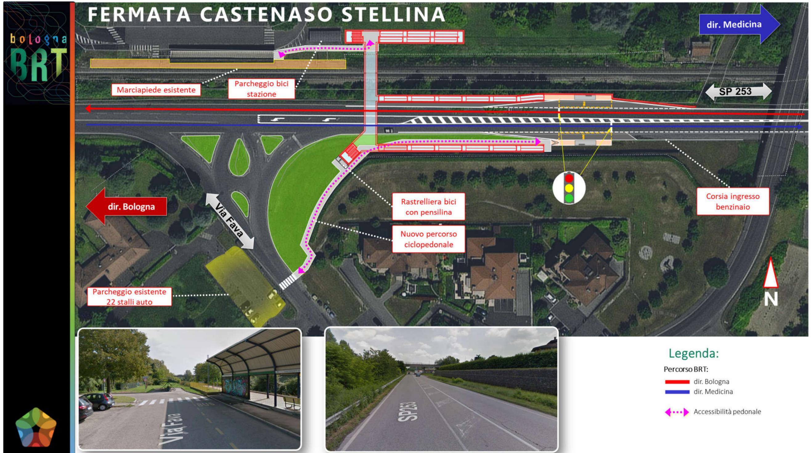
Figura 8-4: configurazione della Fermata Stellina, in corrispondenza della stazione ferroviaria – ipotesi di collegamento diretto BRT-Treno con il solo marciapiede ferroviario nella direzione Da Bologna
