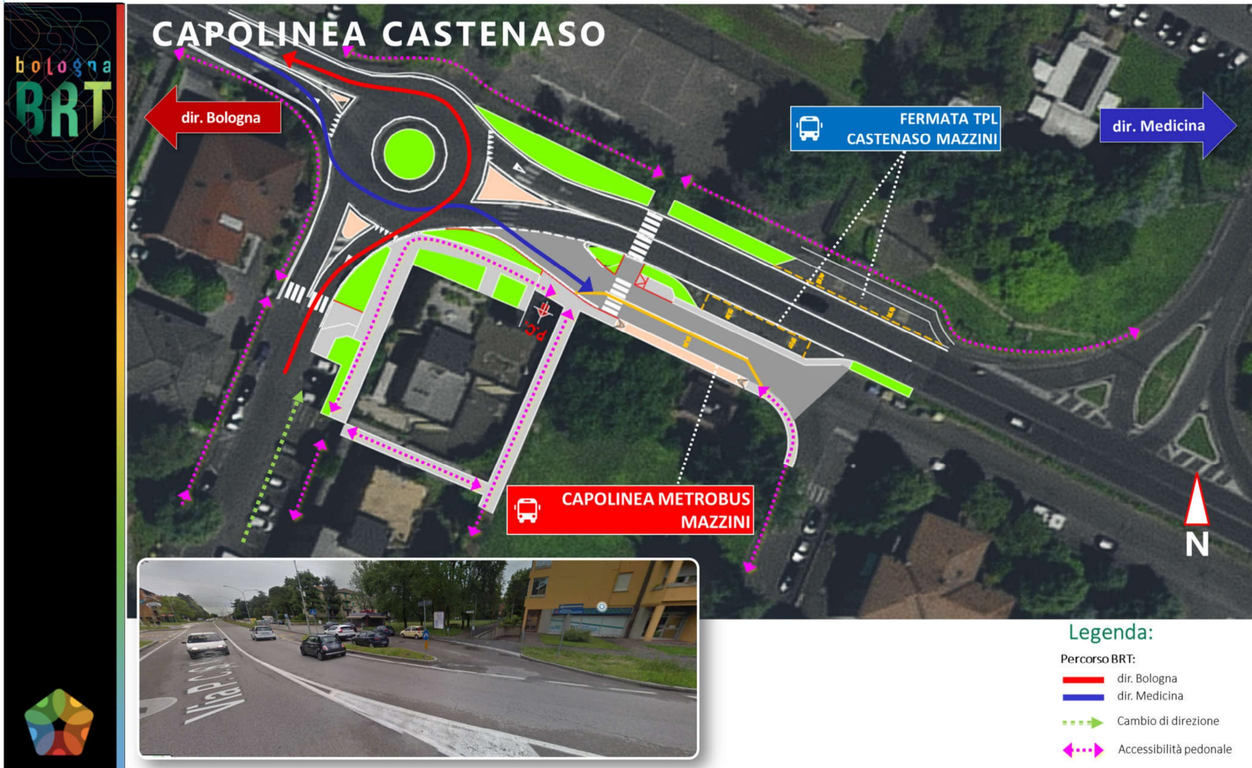
Figura 8-7: configurazione del capolinea presso Castenaso centro e relazione con il TPL esistente.
