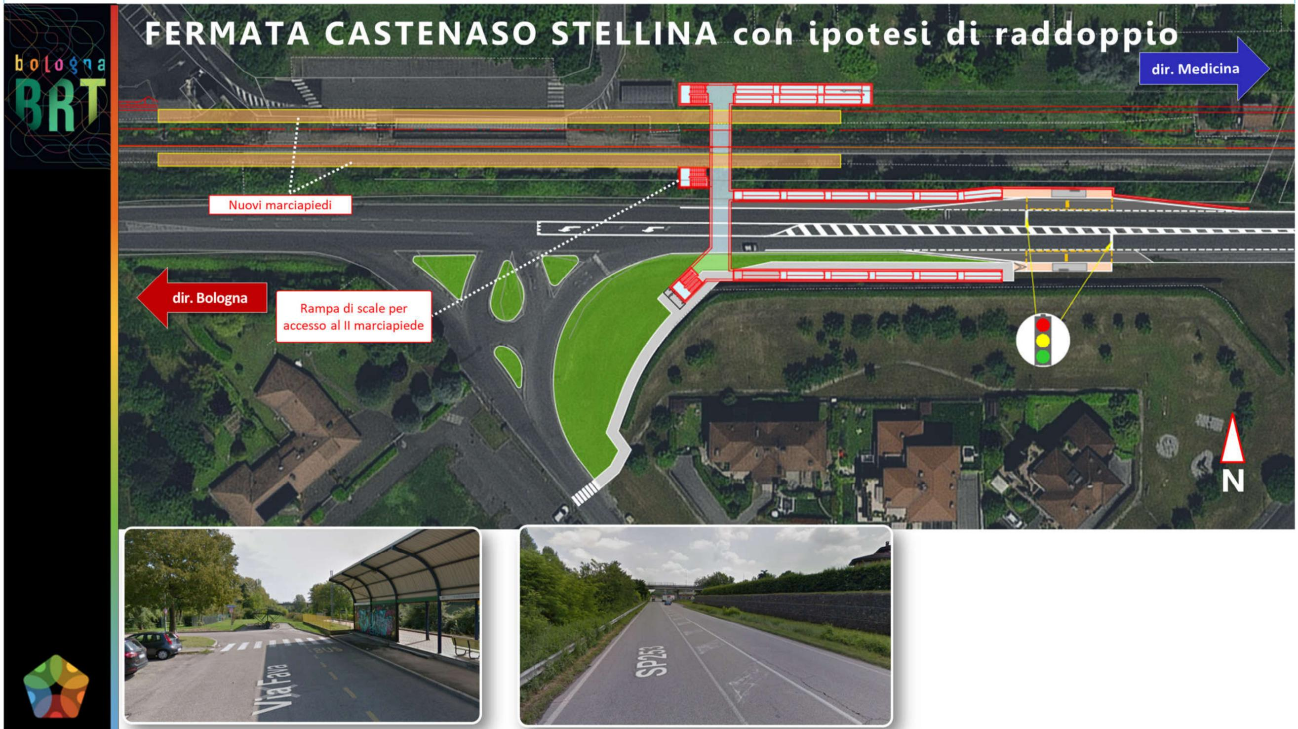
Figura 8-5: configurazione della Fermata Stellina, in corrispondenza della stazione ferroviaria – ipotesi di collegamento diretto BRT-Treno con il marciapiede ferroviario nelle due direzioni Da e Verso Bologna
