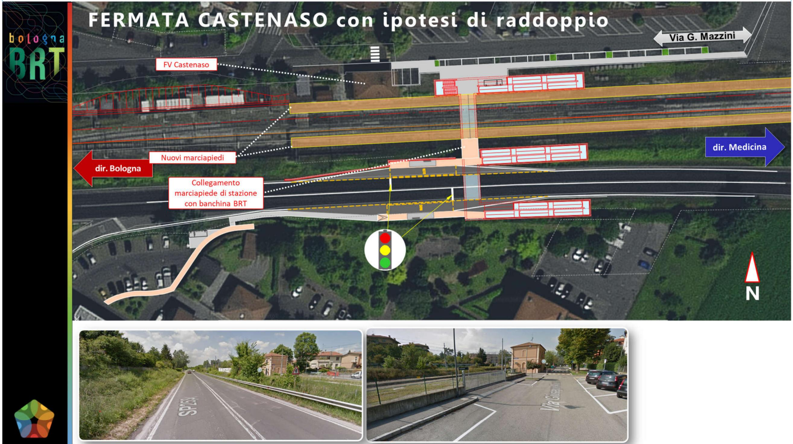
Figura 8-3: configurazione della Fermata Castenaso, in corrispondenza della stazione ferroviaria – ipotesi di collegamento diretto BRT-Treno con il marciapiede ferroviario nelle due direzioni Da e Verso Bologna
