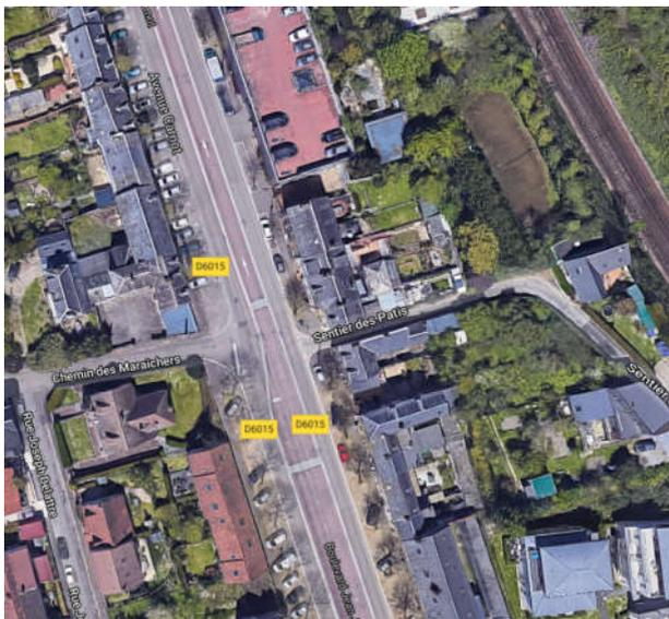
Figura 6—1: esempio di sede riservata, non segregata, con variazione di sezione per il BRT - parte a doppio senso, parte a senso unico - particolare del punto di variazione sezione (Rouen)
