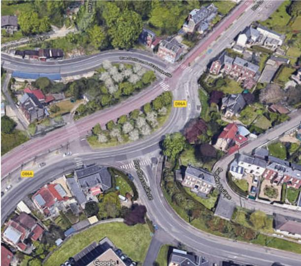
Figura 6—3: esempio di sede in parte riservata, in parte “variante” rispetto alla carreggiata stradale— particolare del punto di intersezione (Rouen)
