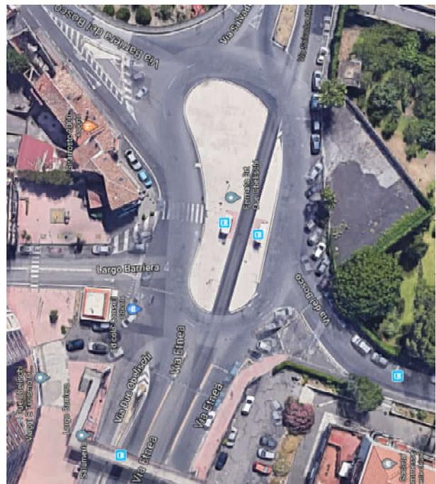
Figura 6—6: esempio di sede segregata, con attraversamento della rotonda gestita “a precedenza”, fermata in rotonda e attraversamento pedonale a livello sfalsato (Catania)
