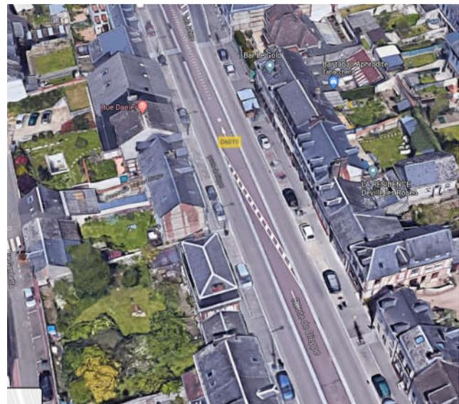
Figura 6—2: esempio di sede riservata, non segregata, con corsia mista per le due direzioni del BRT - particolare del punto di variazione della direzione (Rouen)
