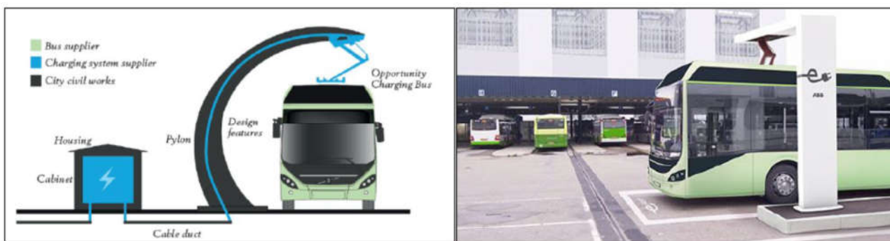
Figura 4-7: schema stazione di “opportunity charging” a pantografo rovesciato (Fonte: Volvo – ABB)
